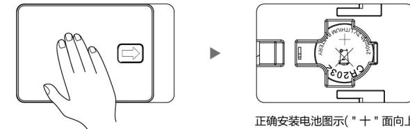
正确安装电池图示 ("十" 面向上)
